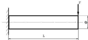
Построить эпюру изгибающих моментов и выполнить расчет бруса на прочность, при условии, что предельно допустимое нормальное напряжение при изгибе:  $[\sigma] \leq 100$  МПа. Брус невесомый.
