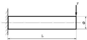
Построить эпюру изгибающих моментов и выполнить расчет бруса на прочность, при условии, что предельно допустимое нормальное напряжение при изгибе:  $[\sigma] \leq 100$  МПа. Брус невесомый.
